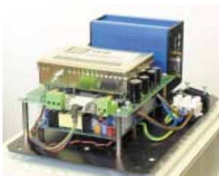
Bild 1: Funkmodem RM 9600 an PB 1000 mit Stromversorgung
